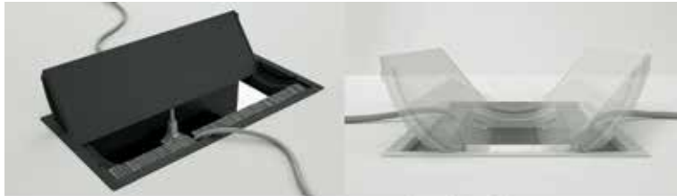
Prise de socle à encastrer Conference - avec 2 prises et 2 chargeurs USB (2 x 5V, 2,4A) - modules keystone (2) à commander séparément - muni d'un câble d'alimentation de 40 cm + fiche Wieland GST18 femelle
