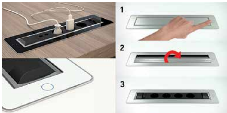
Prise à encastrer type Versaturn - en appuyant sur le bouton, la prise de courant s'ouvre - un capteur détecte la présence d'une prise mâle et empêche ainsi toute fermeture accidentelle
